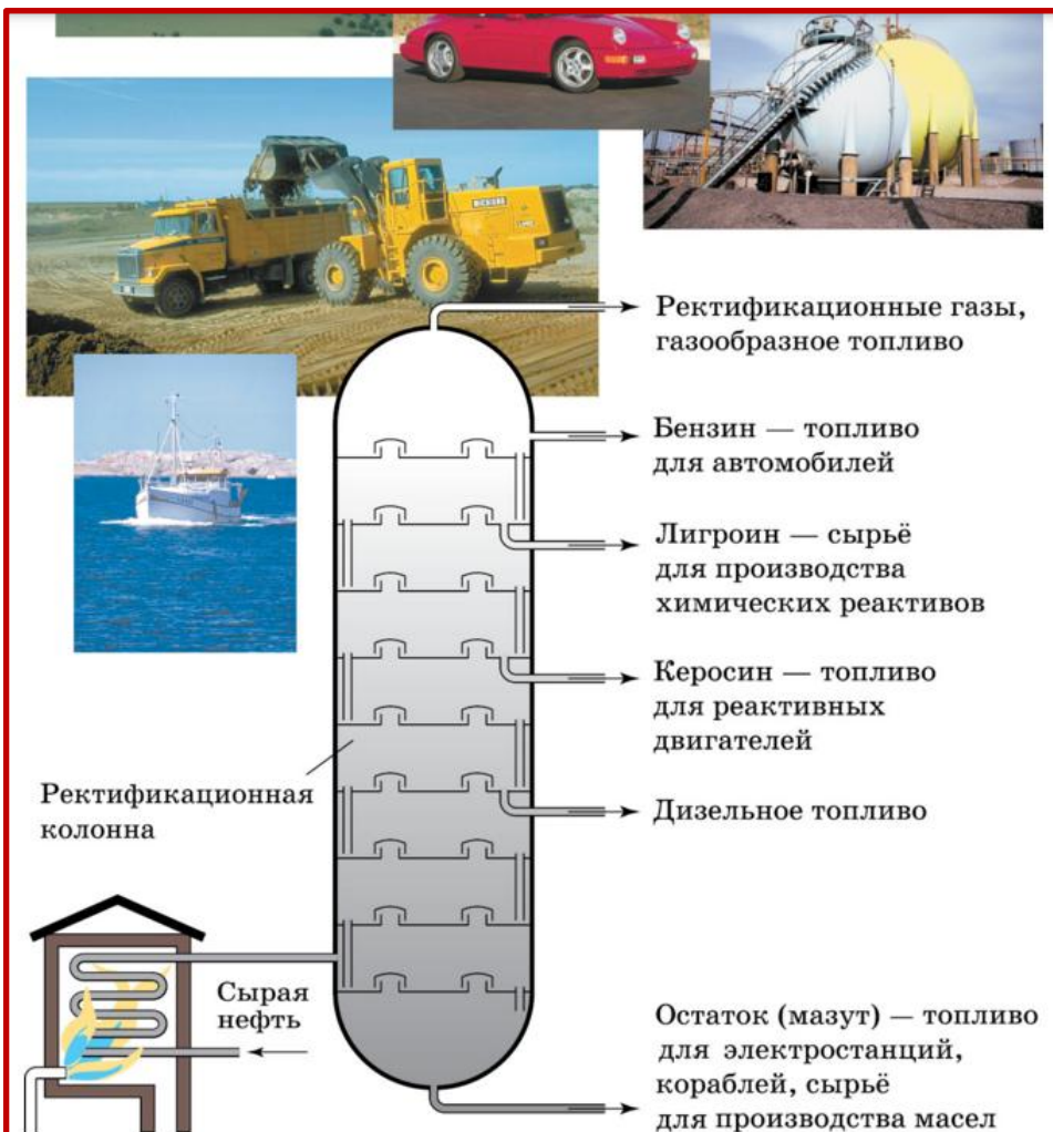
Рис. 35. Схема установки (ректификационной колонны) для непрерывной перегонки нефти и области применения нефтепродуктов
