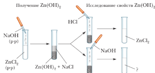
Рис. 69. Схема выполнения опытов по получению гидроксида цинка и исследованию его свойств
