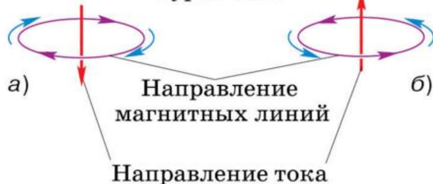
а) б) Направление магнитных линий Направление тока Рис. 96. Применение правила буравчика: проводник с током расположен в плоскости чертежа
