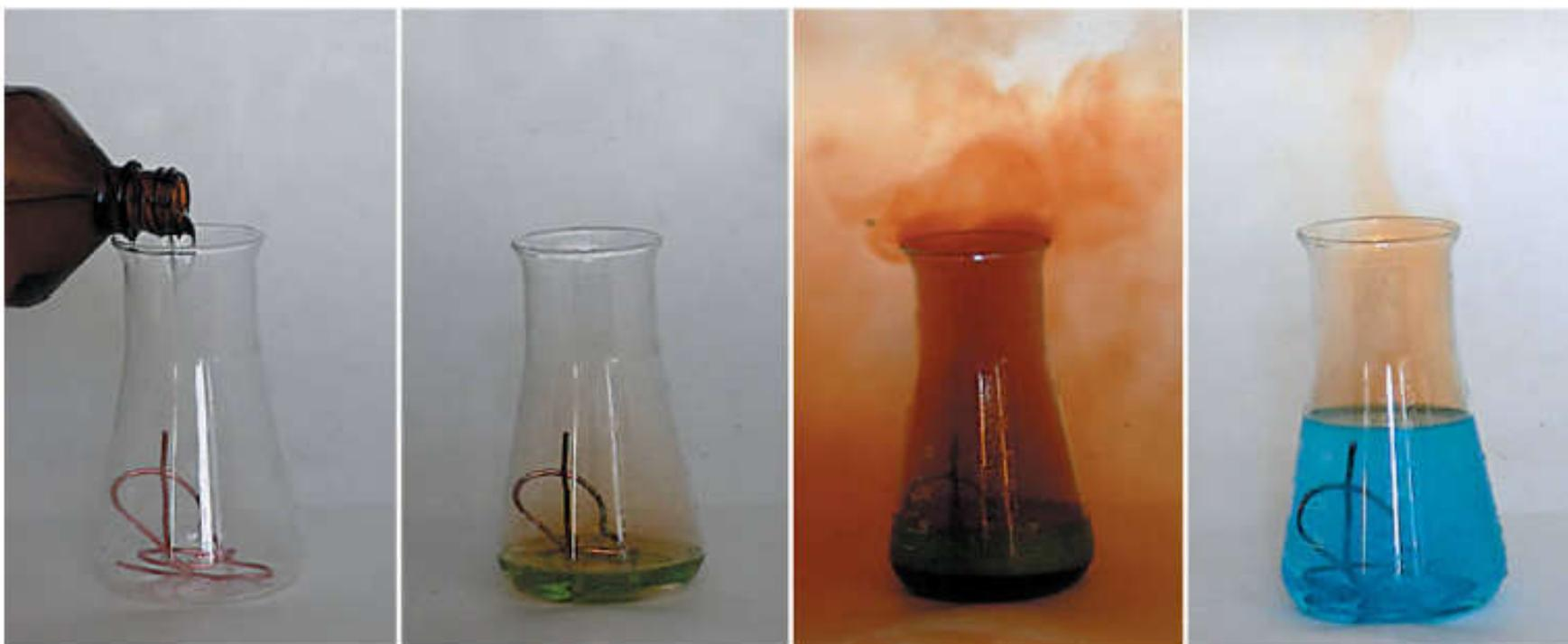
*Рис. 44.* Взаимодействие меди с концентрированной азотной кислотой
