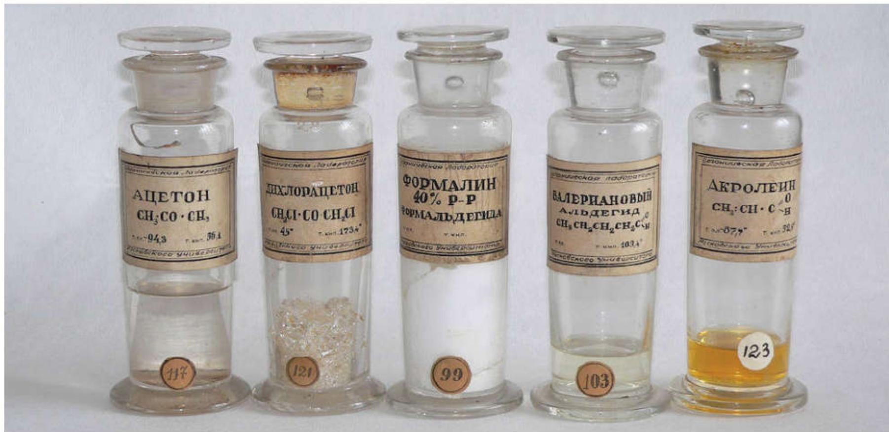
Рис. 87. Карбонильные соединения. На дне склянки с раствором формальдегида (формалина) образуется осадок параформа; цвет акролеина вызван его окислением
