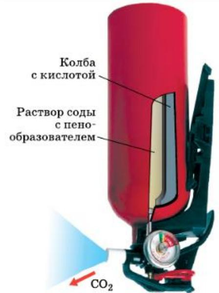
Рис. 13. Кислотный огнетушитель в действии
