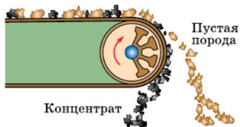
Рис. 167. Обогащение руды на магнитном сепараторе
