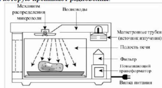
Микроволны могут проходить сквозь стекло, бумагу пластик и фарфор, но не проникают через металл. Для защиты человека от мощного радиоизлучения рабочая камера печи оборудована металлическими стенками со специальным покрытием, отражающим микроволны, а прозрачное стекло в дверце имеет экран из металлической сетки с мелкой ячейкой, которая не пропускает излучение наружу.
