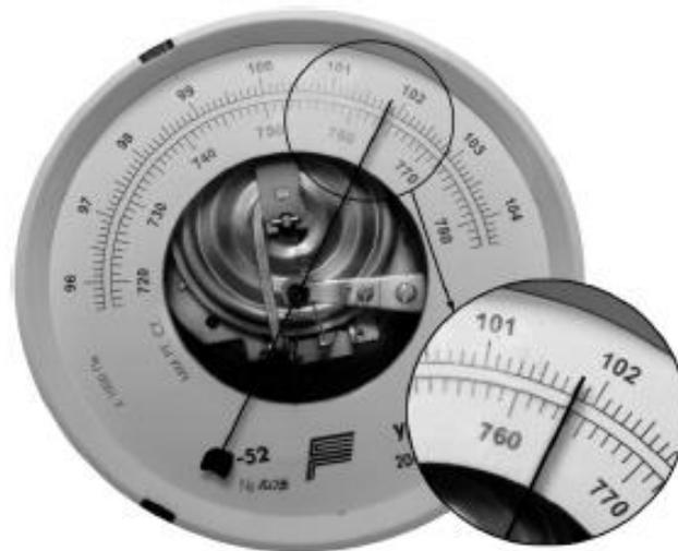
Запишите в ответ показания барометра в мм рт. ст. с учётом погрешности измерений.
