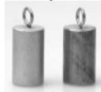
Два цилиндра равной массы (цилиндр пластиковый и цилиндр латунный) на нити
