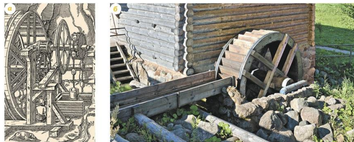
Рис. 6.25. Использование энергии воды: а — водяное колесо, приводящее в действие насос. Иллюстрация из книги Георга Агриколы «De Re Metallica Hibri XII», 1556 г.; б — действующая музейная водяная мельница в д. Бугрово (Псковская область)
