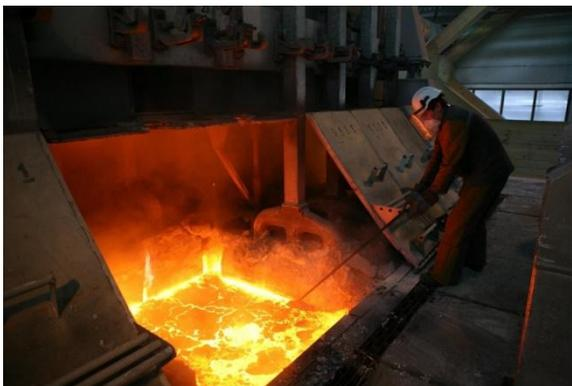
Алюминий получают посредством электролиза. Это – электроемкий процесс.
