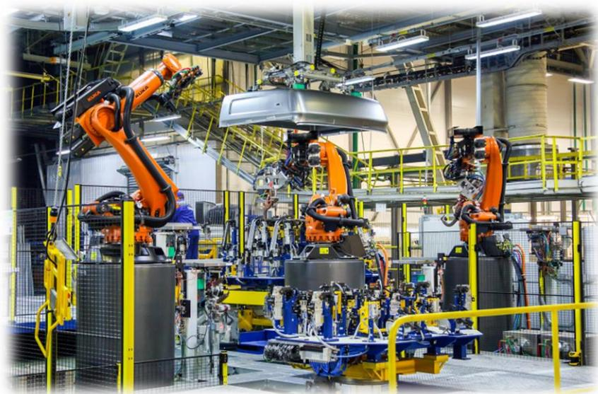
**Роботизированный комплекс для сварки каркасов кабин**
