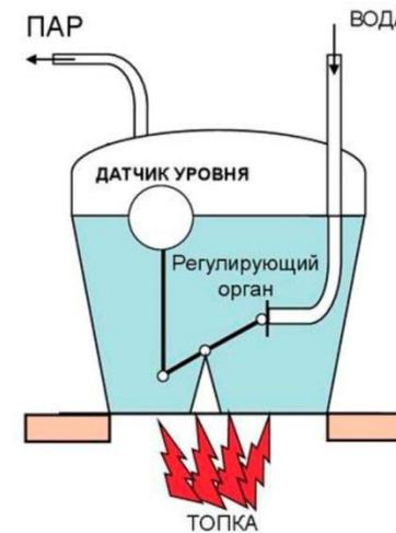
Автоматическую система регулирования уровня воды в паровом котле.
