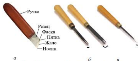
Рис. 8.3. Инструменты для контурной резьбы: а — нож-косяк; б — стамеска-уголок; в — полукруглые стамески
