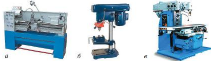
Рис. 10.8. Металлорежущие станки: а — токарный по металлу; б — сверлильный; в — фрезерный
