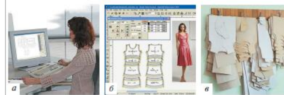
Рис. 6.20. Работа экспериментального цеха: а — разработка конструкции; б — создание экспериментального образца модели; в — готовые лекала
