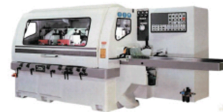
Рис. 3.34. Универсальный строгальный станок для фрезерования заготовок из древесины с четырёх сторон
