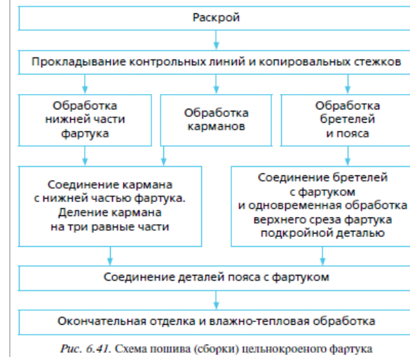
Рис. 6.41. Схема пошива (сборки) цельнокроеного фартука
