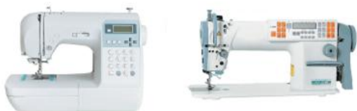
Рис. 6.12. Универсальные швейные машины: а — бытовая; б — промышленная
