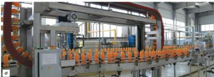
Рис. 2.2. Технологические машины: а — сварочный робот; б — станок-автомат по производству макаронных изделий; в — автоматическая линия фасовки и упаковки товара
