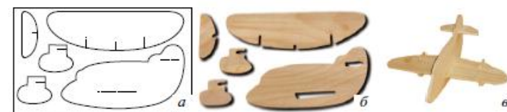
Рис. 3.9. Модель самолёта: а — шаблоны деталей на бумаге; б — заготовки деталей из фанеры; в — модель самолёта без декоративной отделки
