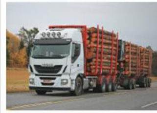
Рис. 3.7. Перевозка леса в хлыстах (стволах)
