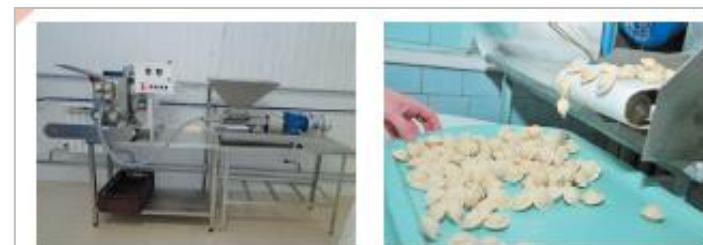
Рис. 6.30. Формованиепельменей в условиях производства (пельменный полуавтомат)
