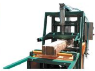
Рис. 3.8. Процесс распиловки бревна на лесопильном станке (пилораме)
