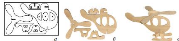
Рис. 3.8. Модель вертолёта: а — шаблоны деталей на бумаге; б — заготовки деталей из фанеры; в — модель вертолёта без декоративной отделки
