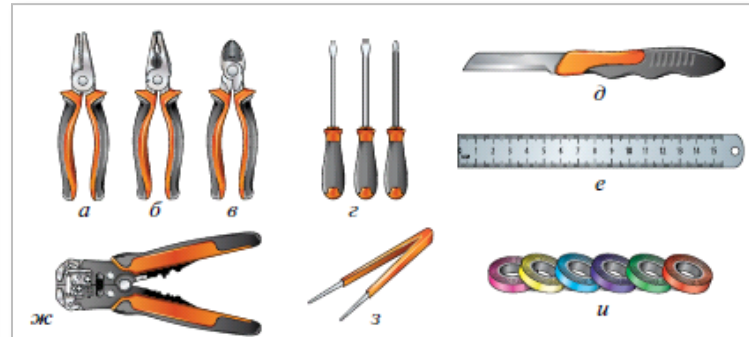
Рис. 10.1. Электромонтажные инструменты и изоляционные материалы: а — круглогубцы; б — плоскогубцы; в — бокорезы; з — отвёртки; д — нож электрика; е — слесарная линейка; ж — приспособление для снятия изоляции; з — пинцет монтажный; и — изоляционные ленты
