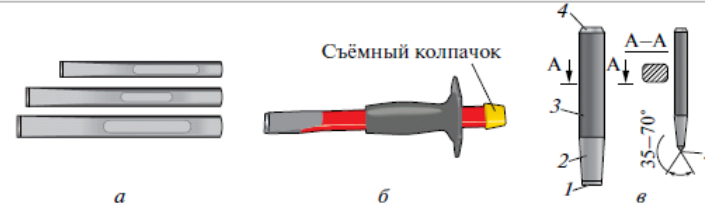
Рис. 5.15. Слесарные зубила: а — разновидности зубил; б — зубило с рукояткой для безопасной работы; в — основные части зубила: 1 — режущая часть (фаска); 2 — режущая часть (клин); 3 — средняя часть; 4 — ударная часть (боёк); 5 — угол заострения
