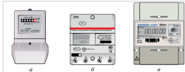
Рис. 10.11. Однофазные счётчики электрической энергии: а — однотарифный; б — двухтарифный; в — многотарифный
