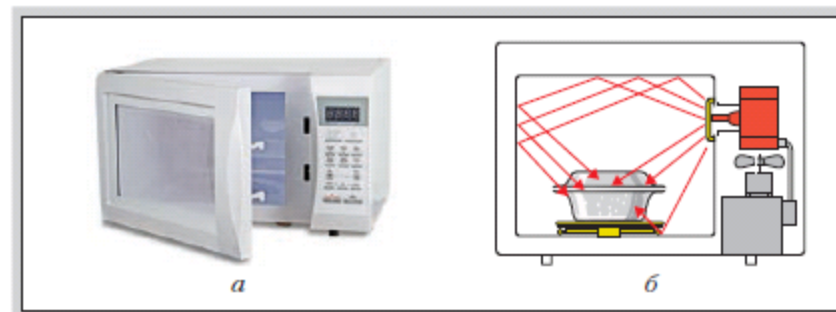
Рис. 158. Микроволновая печь (печь СВЧ): а – внешний вид; б – схема действия
