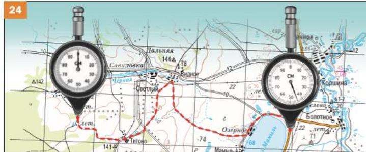
Измерение расстояния курвиметром
