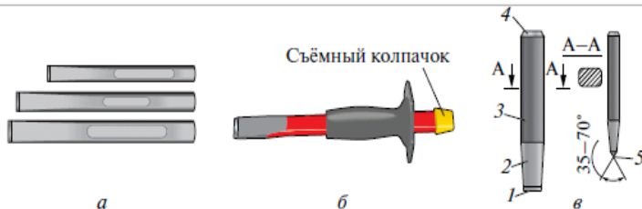
Рис. 5.15. Слесарные зубила: а — разновидности зубил; б — зубило с рукояткой для безопасной работы; в — основные части зубила: 1 — режущая часть (фаска); 2 — режущая часть (клин); 3 — средняя часть; 4 — ударная часть (боёк); 5 — угол заострения
