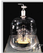
Рис. 140. Эталонный килограмм из сплава платины и иридия, хранящийся в Международном бюро мер и весов (Франция) с XIX в.
