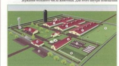
**Рис. 19.** Устройство животноводческой фермы: 1, 2, 3 — помещения для животных; 4 — ветеринарная служба; 5 — выгульные площадки; 6 — кормонез; 7 — сеновал; 8 — дренажные траншеи; 9 — кормонез для коров (башня); 10 — силосные траншеи; 11 — кормонез для коров; 12 — навозохранилище; 13 — навозохранилище; 14 — санитарный прицеп; 15 — помещения для персонала; 16 — площадка для овец; 17 — служебная ступенька.
