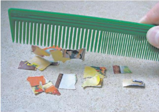
В этом простом опыте мы наблюдаем электрическое взаимодействие. Назвали его так потому, что удивительное свойство натёртого шерстью янтаря притягивать мелкие предметы заметили ещё древние греки, а янтарь по-гречески — «электрон».
