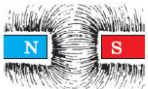
Рис. 114. Магнитные линии двух магнитов
