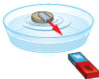
Рис. 59. Изменение скорости движения кусочка железа под действием магнита
