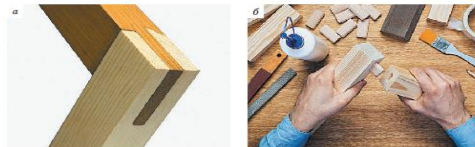
Рис. 21.1. Шиповые соединения: а — одинарным шипом; б — серединное соединение
