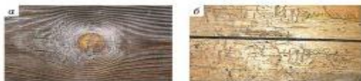
Рис. 2.7. Недостатки древесины: а — сучок; б — червоточины и трещины
