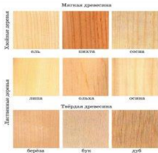
Рис. 2.6. Виды древесины по твёрдости (стойкости к деформированию или разрушению при силовом воздействии)
