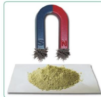
Рис. 27. Разделение смеси железных опилок и порошка серы с помощью магнита
