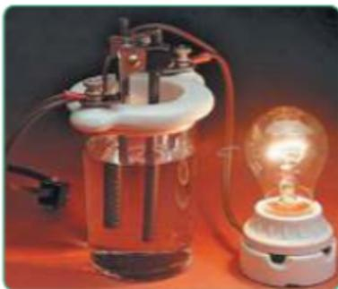
Рис. 7. Прибор для определения электропроводности растворов
