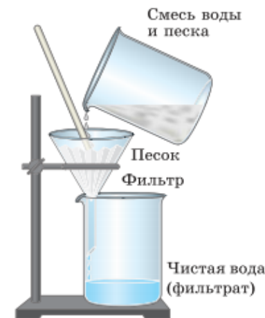
Рис. 1. Фильтрация раствора в лаборатории
