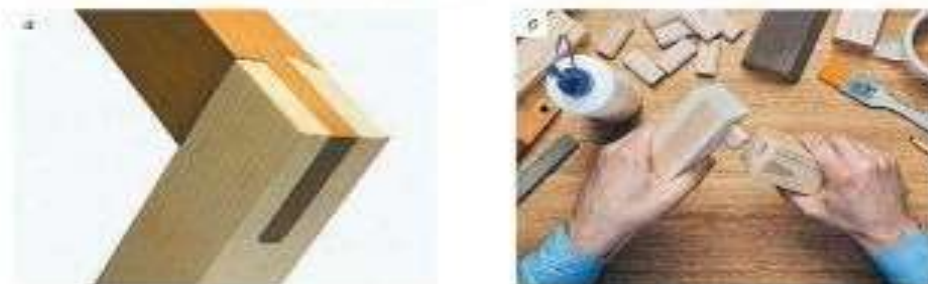
Рис. 21.1. Шиповые соединения: а — одинарный шипом; б — среднее соединение
