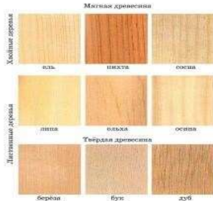
Рис. 2.6. Виды древесины по твёрдости (стойкости к деформированию или разрушению при сдавливании)
