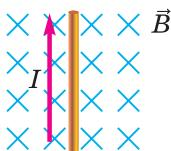
а) Как направлена действующая на проводник сила Ампера?
